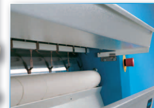
Deux couloirs démontables pour ramasser les tissus soit à l'entrée que à la sortie
